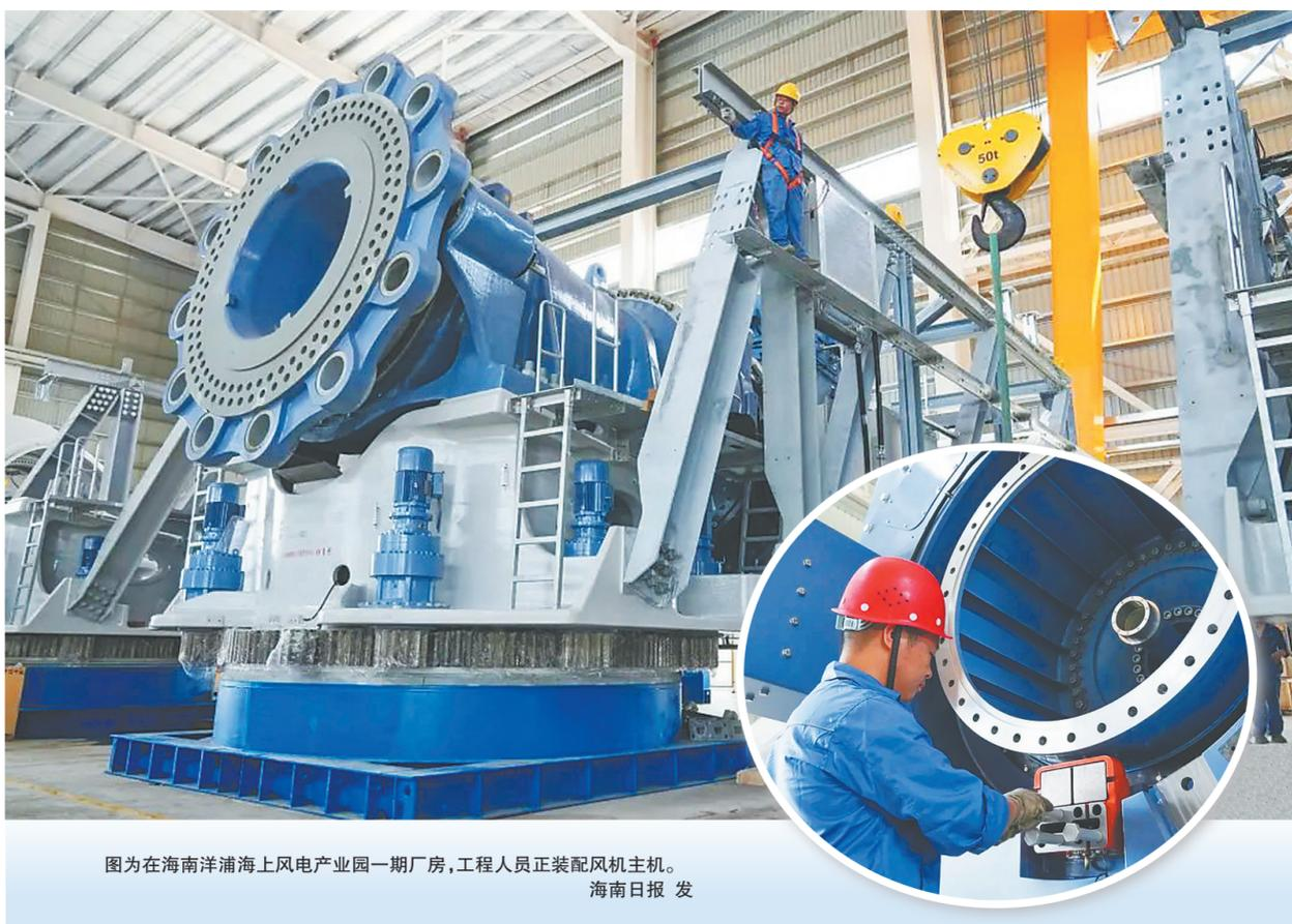
图为在海南洋浦海上风电产业园一期厂房，工程人员正装配风机主机。 海南日报 发
