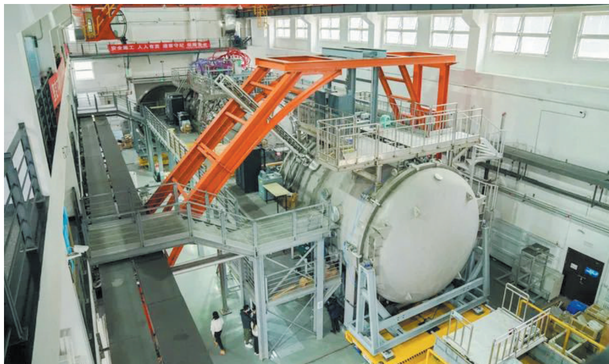
▲这是哈尔滨工业大学空间环境地面模拟装置空间等离子体环境模拟与研究系统(资料照片)。 新华网 发
