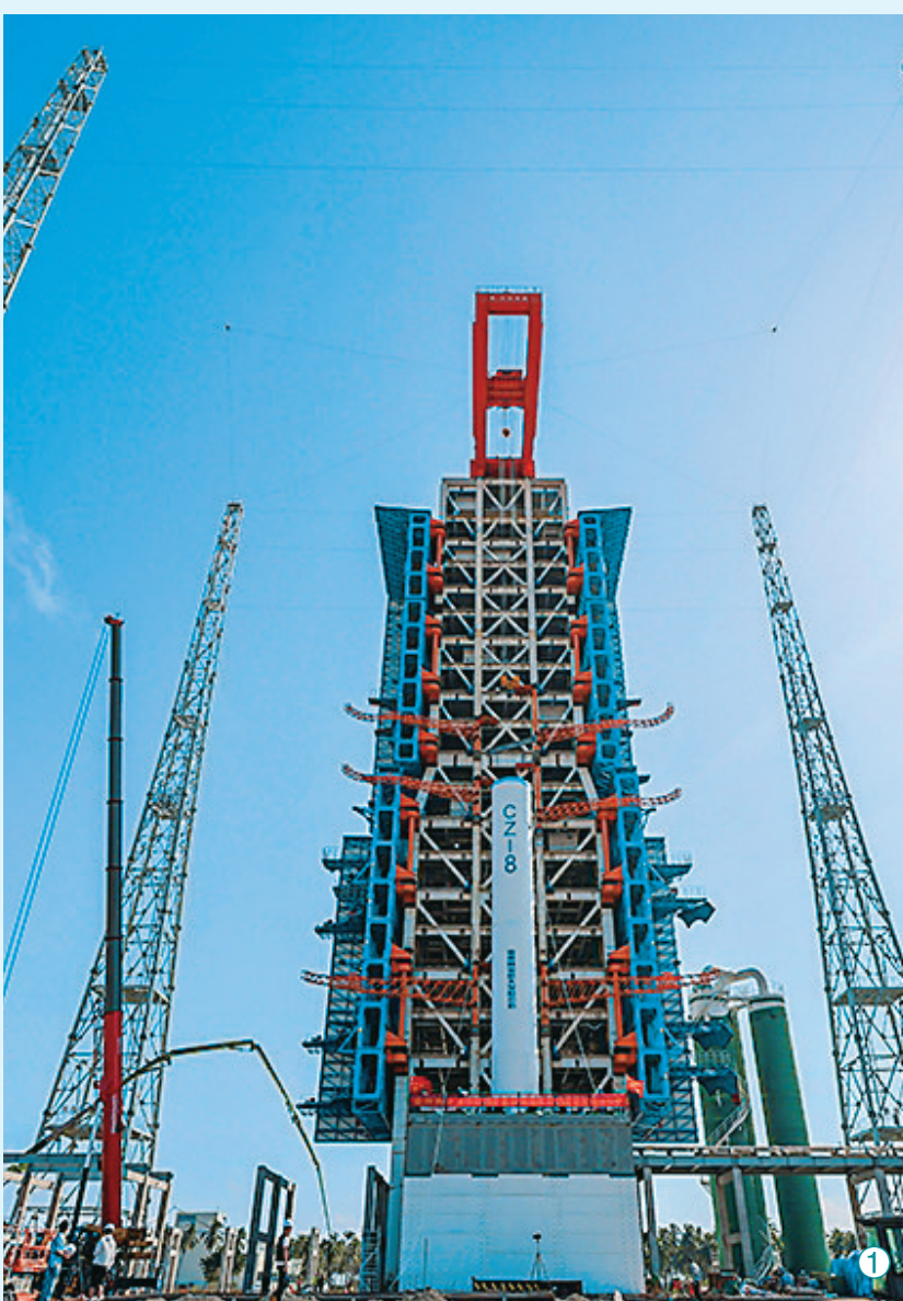
①2月1日,海南国际商业发射中心在一号发射工位开展吊装训练。此次吊装训练的模拟箭是仿制 CZ-8 基本型火箭设计制造。 ②③海南国际商业航天发射中心一号发射工位吊装训练现场。 中新网 发
